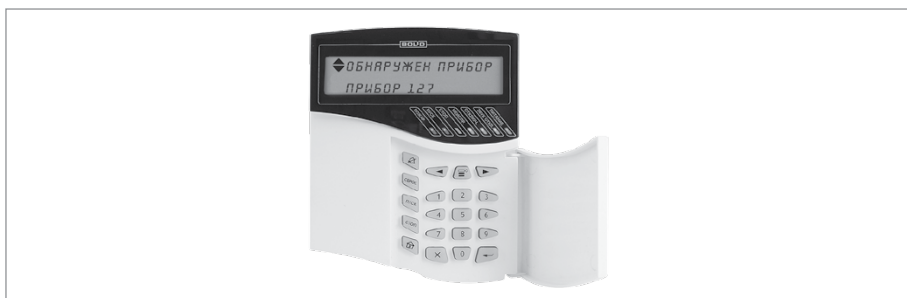
Рисунок 1. Индикатор пульта «С2000М» с соответствующим сообщением
