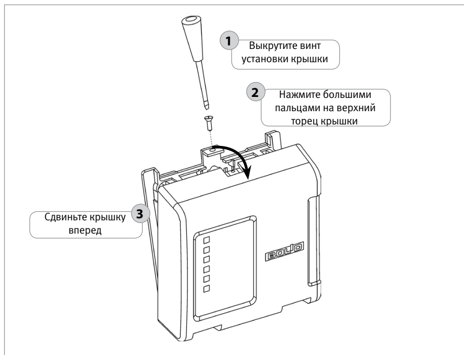
Рисунок 37. Снятие крышки изделия
