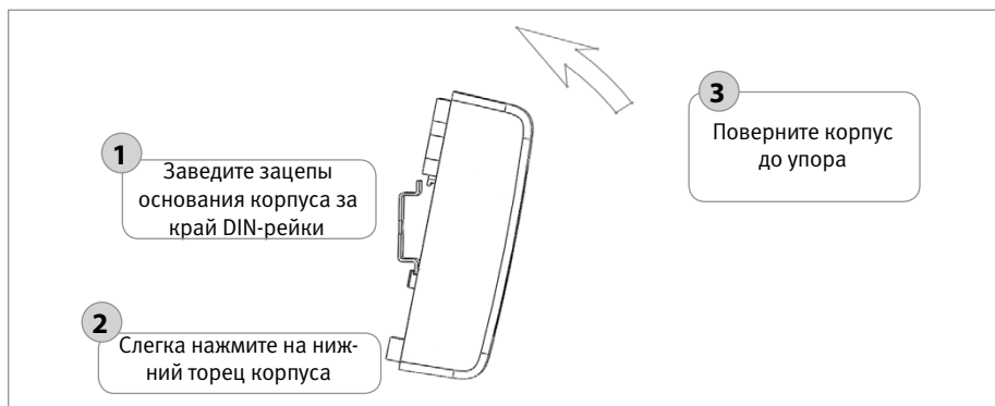
Рисунок 22. Порядок установки прибора на DIN-рейку
