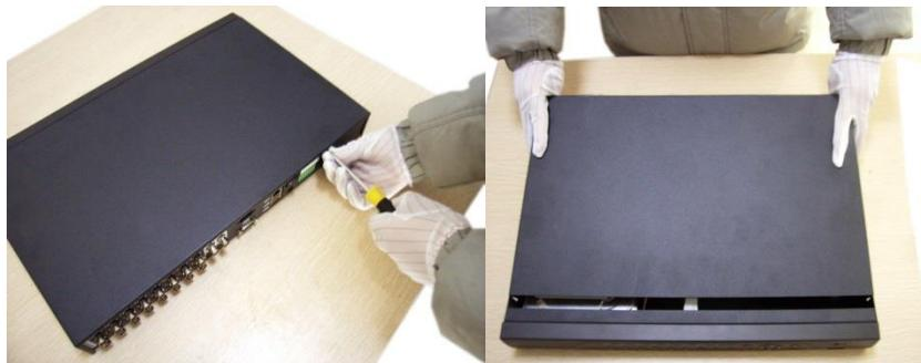
Открутите шурупы и снимите верхнюю крышку устройства
